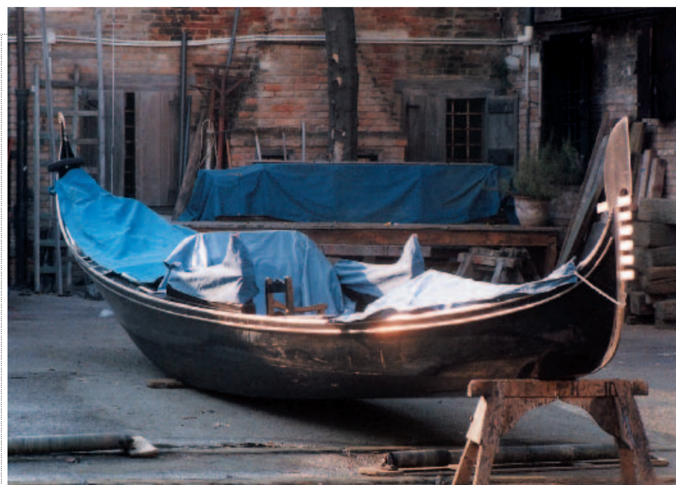
Le misure. Ogni barca si compone di 280 pezzi, la lunghezza è di 10,84 metri, la larghezza 1,42 e arriva a pesare 600 chili (foto: annatoscano)
